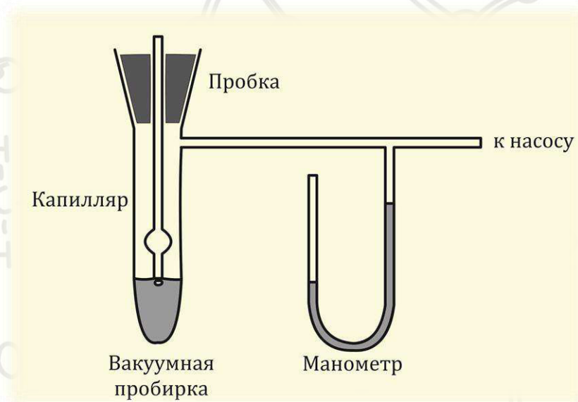
Схема прибора для измерения поверхностного натяжения
