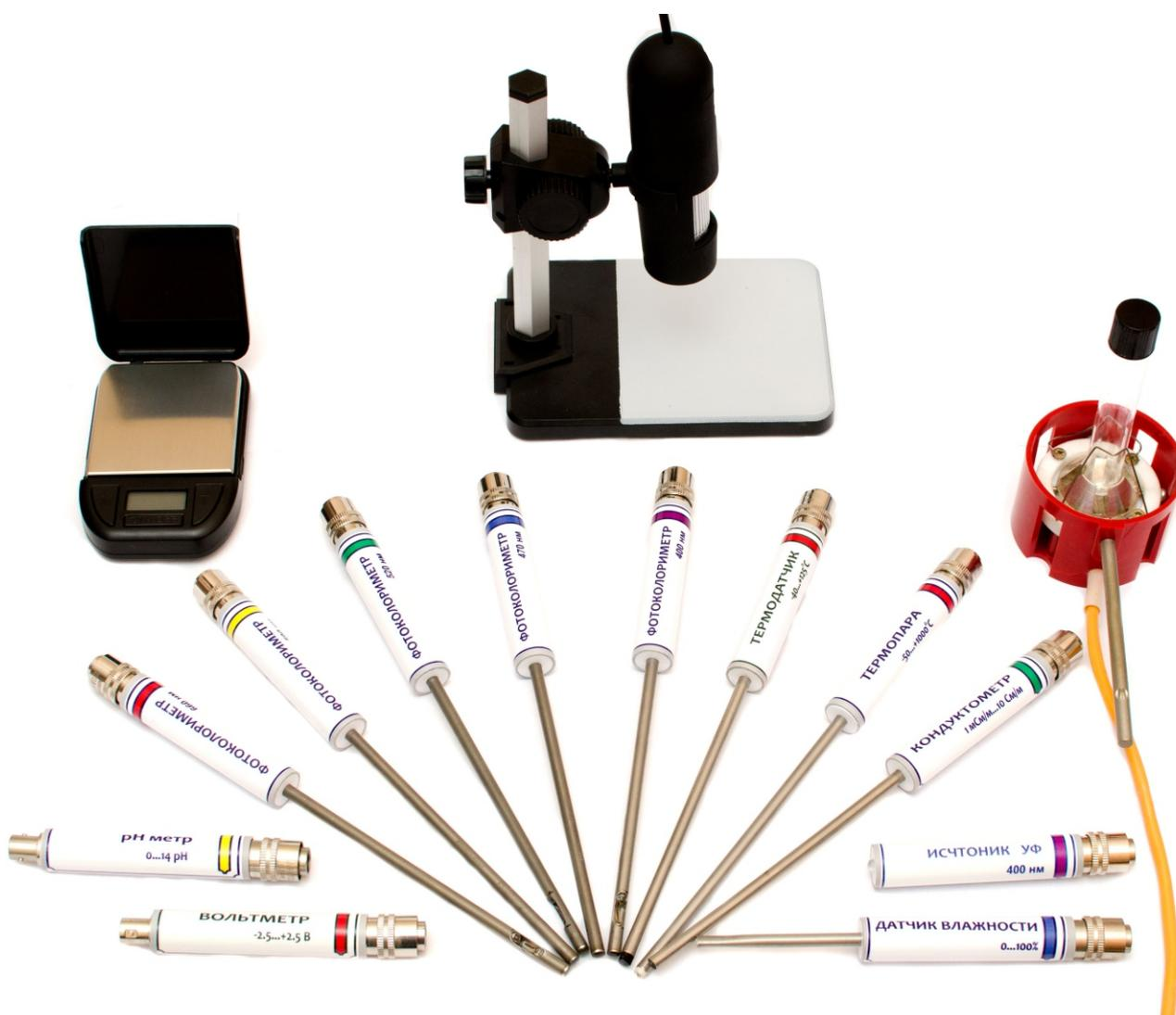
2. В состав комплекса входит: световой USB микроскоп, лабораторные весы.
